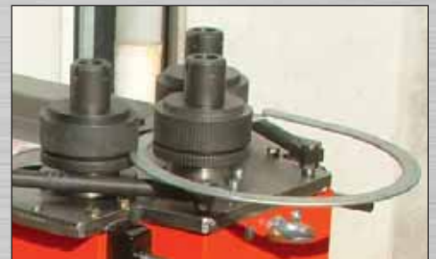
BENDING FLAT BAR ON EDGE
